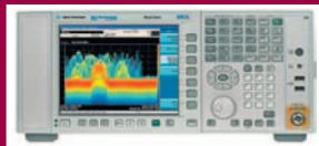
Благодаря полосе демодуляции до 160 МГц, анализаторы MXA обеспечивают точный анализ сигналов перспективных стандартов беспроводной связи.
