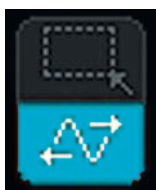
Рис. 6. Кнопки режима, позволяющие выбирать между манипуляцией окном масштабирования и осциллограммой
