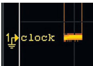
Рис. 5. Для перетаскивания осциллограммы вверх и вниз используется значок «земли»
