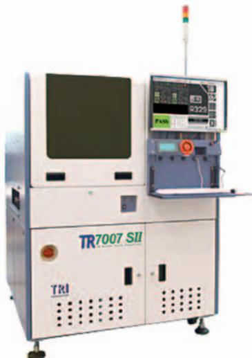
Скорость инспекции прибора достигает практически 200 см<sup>2</sup>/с, поэтому TR7007 SII претендует на звание самой быстрой системы по исследованию свойств паяльной пасты с применением технологии 3D. Полное 3D исследование происходит при разрешении 15 или 10 мкм.
