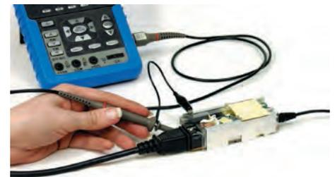
Рис. 6. Измерение напряжения с плавающим потенциалом осциллографом с батарейным питанием
