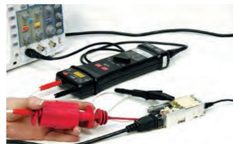
Рис. 9. Применение дифференциального пробника для измерений с плавающими потенциалами
