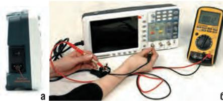
Рис. 2. «Земляной» вывод сети источника питания осциллографа (а) и проверка наличия «сетевой земли» на входе прибора (б)
