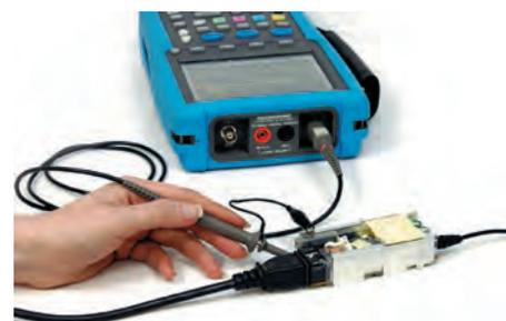
Рис. 10. Использование осциллографа с изолированными каналами ADS-4232
