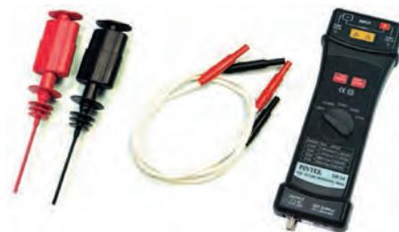
Рис. 8. Дифференциальный пробник DP-50
