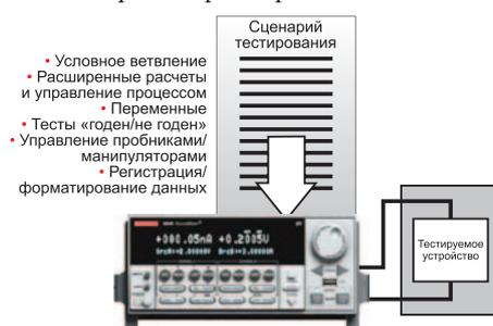
Рис. 1. Технология TSP исполняет полные тестовые программы из энергонезависимой памяти прибора
