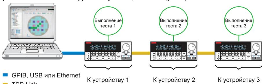
Рис. 2. Параллельное тестирование (подключение по одному источнику-измерителю на каждую контрольную точку) с применением TSP и TSP-Link повышает пропускную способность и сокращает стоимость тестирования
