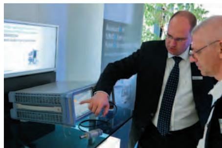
базовой полосой пропускания 350 и 500 МГц. Данная модель осциллографа выпускается для замещения осциллографов серии R&S RTM1054/1052. Приборы доступны в 2-х/4-х канальных модифика-
