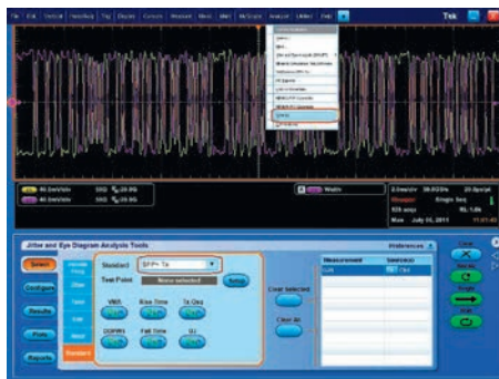
Рис. 3. Интерфейс пользователя SFP-Tx позволяет настраивать и запускать тесты, выбирая их из меню
