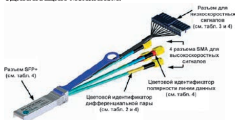
Рис. 1. Выпускается два варианта тестовой оснастки — одна с DC блоками и оконечной нагрузкой, а другая без них
