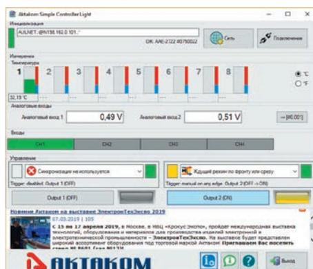
Рис. 2. Приложение Aktakom Smart Controller Light
