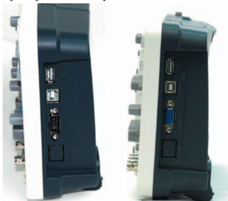
Рис. 2. Боковая панель прибора: разъем RS-232 (для моделей ADS-2xxxM) или VGA (для моделей ADS-2xxxMV)
