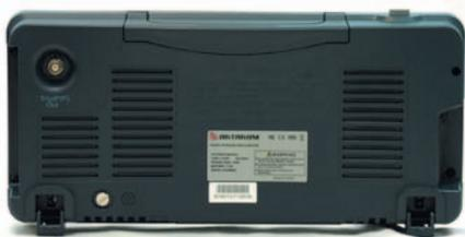
Рис. 5. Задняя панель прибора (на задней панели: разъем выхода Pass/Fail (годен/негоден), винт для подключения к «земле»)
