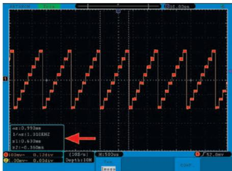
Рис. 35. Проведение курсорных измерений по временным/частотным параметрам в осциллографах ADS-2xx1M(MV)
