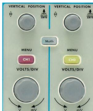
Рис. 7. Элементы управления вертикальной разверткой
