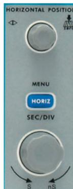
Рис. 8. Элементы управления горизонтальной разверткой
