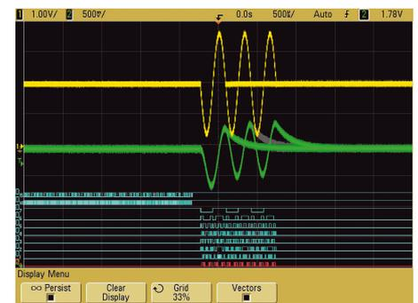
**Рис. 5.** Стандартный запуск по фронту не позволяет осуществить синхронизацию по ЛЧМ сигналам определенной длительности
