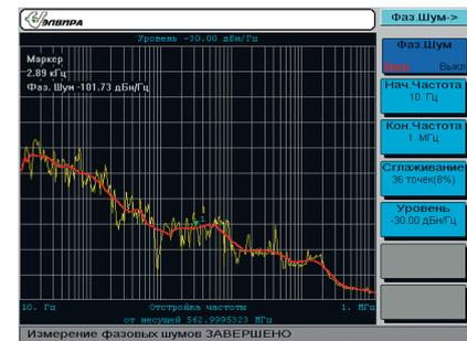
**Рис. 12. Измерение фазовых шумов на СК4-БЕЛАН 32 при помощи специализированного ПО, входящего в стандартную комплектацию**
