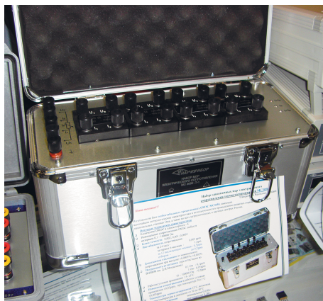
Набор однозначных мер электрического сопротивления термостатированный МС3050Т
