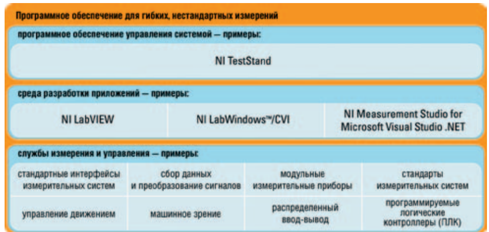
Рис. 5. Уровни программного обеспечения, часто используемые в модульной измерительной системе
