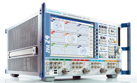
Рис. 1. Векторные анализаторы цепей Rohde & Schwarz семейства ZVA обеспечивают измерение истинно дифференциальных сигналов, что позволяет исключить всякие допущения при определении характеристик активных дифференциальных компонентов
