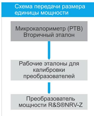
Рис. 1. Схема передачи размера единицы мощности для преобразователей мощности серии R&S@NRV. Микрокалориметр и вторичный эталон образуют первичный национальный эталон
