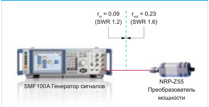
Рис. 2. Определение уровня мощности генератора R&S@SMF100A с помощью преобразователя мощности R&S@NRP-Z55 в качестве эталона. Максимальная погрешность измерения из-за рассогласования составляет 0,18 дБ на 18 ГГц (без гамма-коррекции)
