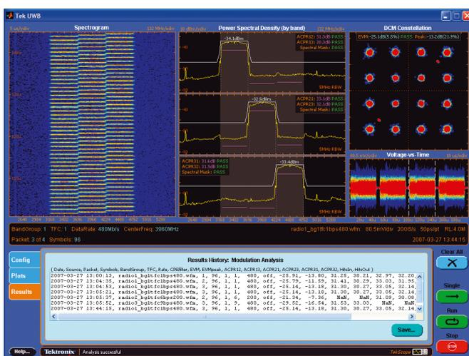
Рис. 4. Функция UWB анализа обеспечивает собой полный набор измерений и диаграмм для каждого пакета данных
