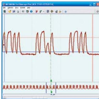
Рис. 12. Пример осциллограммы синхронизации по ранту для виртуального осциллографа АКТАКОМ АСК-3102 1Т
