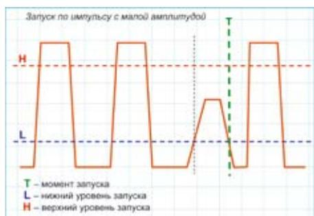
Рис. 11. Алгоритм синхронизации по ранту
