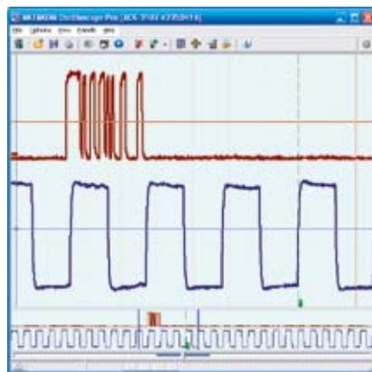
Рис. 18. Пример запуска синхронизации по третьему импульсу на канале 2, после обнаружения фронта на канале 1 и задержки в 10 мкс
