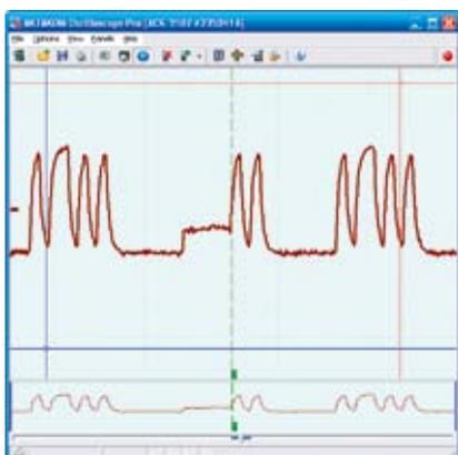
Рис. 10. Режим поиска импульса с заданной длительностью фронта виртуального цифрового осциллографа АКТАКОМ АСК-3102 1Т
