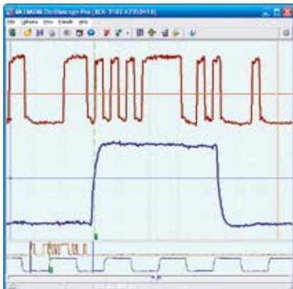
Рис. 16. Пример синхронизации по схеме «И» двух входных каналов в осциллографе АСК-3102 1Т
