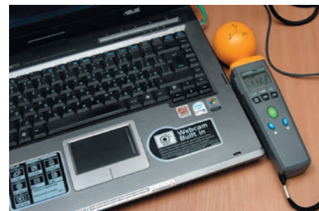
Рис. 5. Измерение напряженности электрического поля ПК с включенным Wi-Fi. Максимальное значение составляет 1,122 В/м
