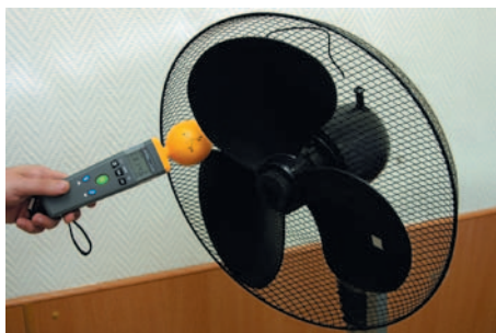
Рис. 7. Измерение напряженности электрического поля выключенного вентилятора («естественный» фон). Максимальное значение составляет 314,6 мВ/м
