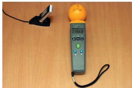
Рис. 3. Измерение напряженности электрического поля Yota WiMax. Максимальное значение составляет 15,68 В/м
