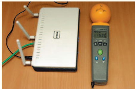
Рис. 2. Измерение напряженности электрического поля Wi-Fi роутера. Максимальное значение составляет 15,90 В/м
