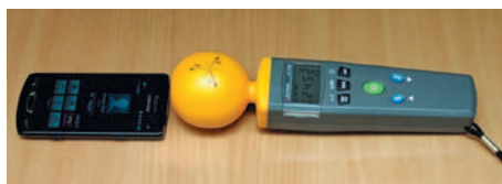
Рис. 1. Измерение напряженности электрического поля сотового телефона. Максимальное значение составляет 24,52 В/м
