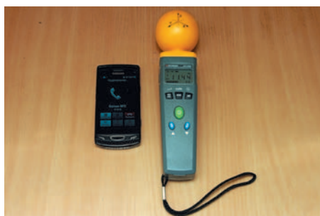
Рис. 10. Антенна телефона не направлена на датчик. Телефон в непосредственной близости от датчика. Максимальное значение напряженности электрического поля 11,44 В/м
