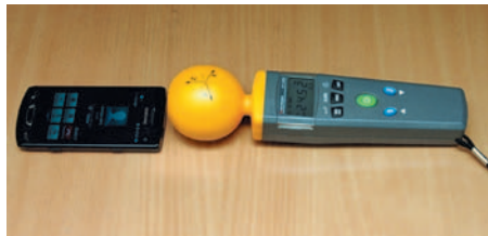
Рис. 9. Антенна телефона направлена на датчик. Телефон в непосредственной близости от датчика. Максимальное значение напряженности электрического поля 24,52 В/м
