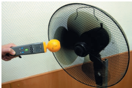
Рис. 8. Измерение напряженности электрического поля включенного вентилятора. Максимальное значение составляет 325,4 мВ/м
