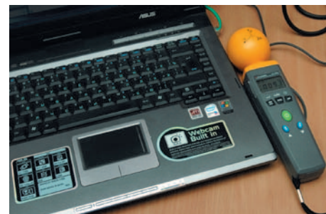
Рис. 6. Измерение напряженности электрического поля ПК с выключенным Wi-Fi («естественный» фон). Максимальное значение составляет 9,3 мВ/м
