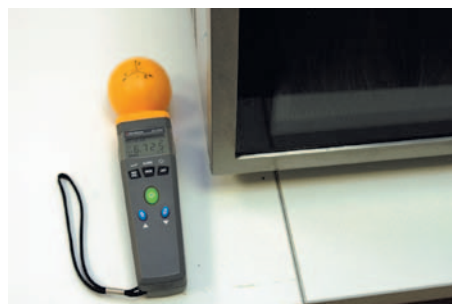
Рис. 4. Измерение напряженности электрического поля СВЧ печи. Максимальное значение составляет 6,725 В/м
