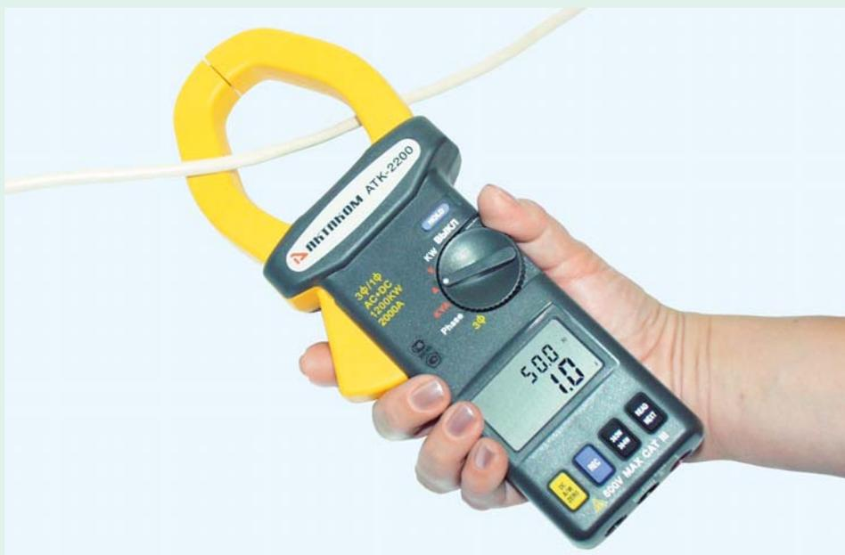
Рис. 1. Многофункциональные токовые клещи ATK-2200
