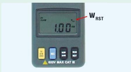
Рис. 8. Дисплей прибора в режиме измерения мощности при несимметричной нагрузке для трех фаз на четырех проводах
