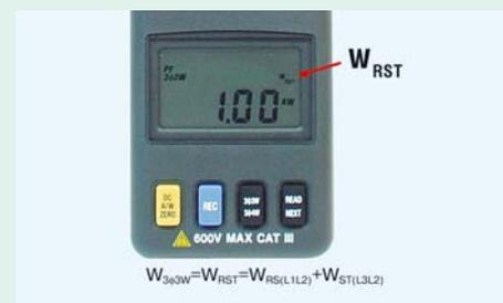
Рис. 6. Дисплей прибора в режиме измерения мощности при несимметричной нагрузке для трех фаз на трех проводах
