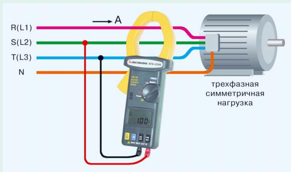
Рис. 3. Измерение мощности переменного и постоянного тока при симметричной нагрузке для трех фаз
