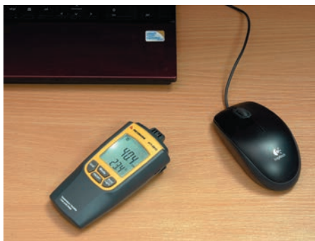
Рис. 24. Измерения влажности и температуры на рабочем месте с помощью АТТ-5010
