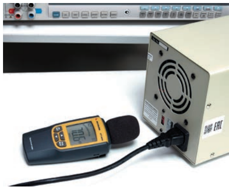
Рис. 20. Измерение уровня звука с помощью АКТАКОМ АТТ-9080
