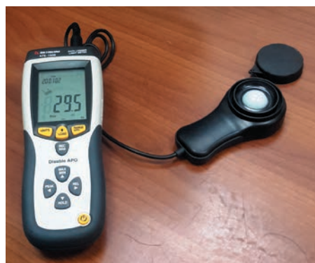
Рис. 14. Измерение параметров освещенности на рабочем месте в офисе люксметром АТЕ-1509
