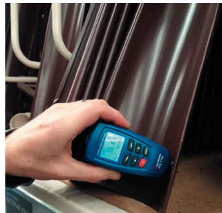
Рис. 3. Измерение АТЕ-7156 толщины покрытия водосточного желоба
