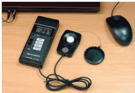
Рис. 17. Измерения люксметром АТТ-1508 уровня освещенности на рабочем месте
