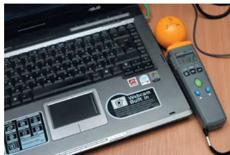
Рис. 11. Измерение напряженности электрического поля ПК с включенным Wi-Fi
