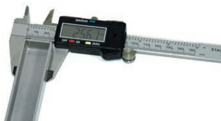
Рис. 7. Измерение штангенциркулем АКТАКОМ АТТ-7015 наружных размеров изделия
