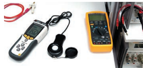
Рис. 15. Измерение параметров освещенности на производственном участке
