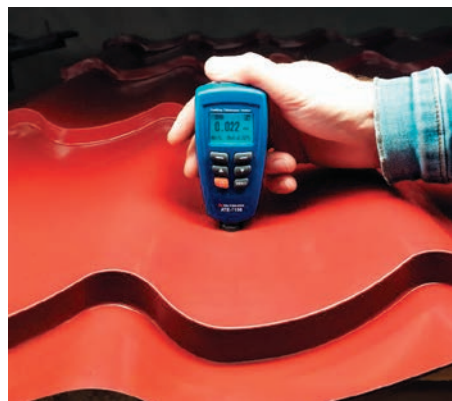
Рис. 2. Измерение АТЕ-7156 толщины покрытия металлочерепицы
