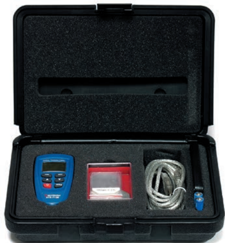
Рис. 4. Толщиномер АТЕ-7156 в пластиковом кейсе
