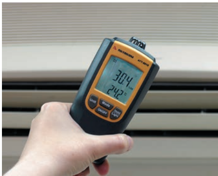
Рис. 25. Измерения влажности и температуры с помощью АТТ-5010
