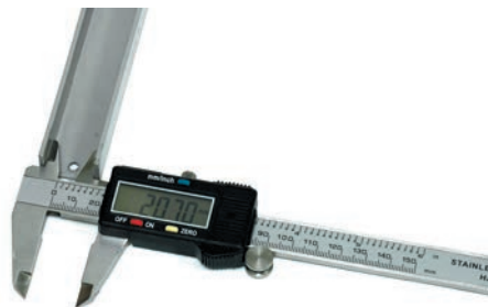
Рис. 6. Измерение штангенциркулем АКТАКОМ АТТ-7015 внутренних размеров изделия
