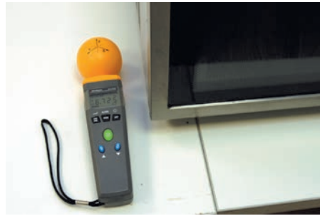
Рис. 10. Измерение напряженности электрического поля СВЧ печи
