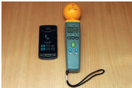
Рис. 9. Измерение напряженности электрического поля сотового телефона
