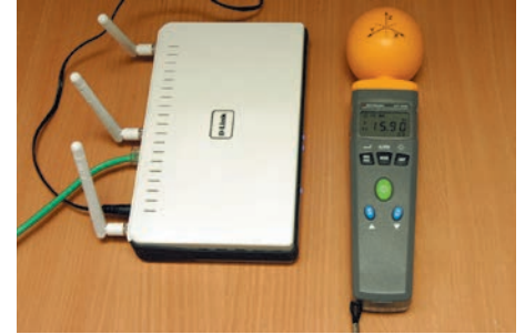
Рис. 12. Измерение напряженности электрического поля Wi-Fi маршрутизатора
