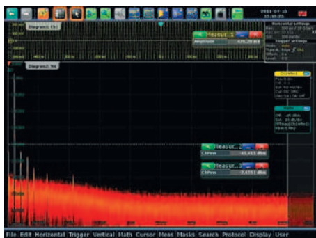
Рис. 10. Снимок экрана при измерении значения ENOB непосредственно на RTO
