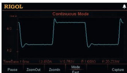
Рис. 12. Отображение непрерывного динамического режима работы в графическом виде на экране прибора
