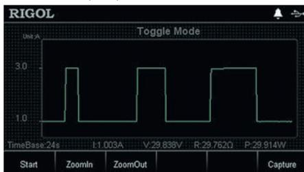
Рис. 18. Отображение режима срабатывания по одиночному импульсу в графическом виде
