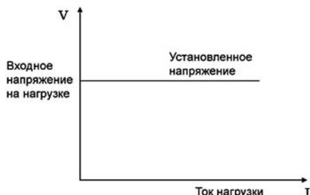
Рис. 4. Зависимость напряжения от тока в режиме постоянного напряжения (CV)
