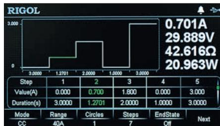
Рис. 20. Экранный интерфейс при задании параметров в режиме работы по списку
