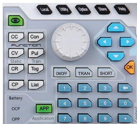
Рис. 2. Органы управления электронной нагрузки DL3021 на передней панели прибора
