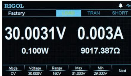
Рис. 27. Экранный интерфейс в режиме тестирования источников питания на соответствие заявленным заводским параметрам
