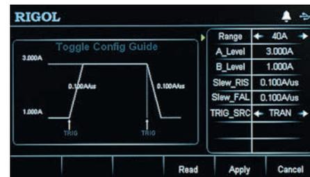
Рис. 17. Экранный интерфейс при задании параметров в режиме срабатывания по одиночному импульсу
