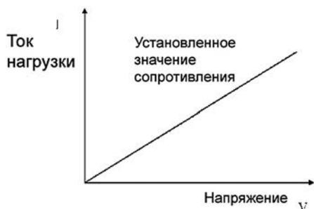
Рис. 5. Зависимость тока от напряжения в режиме постоянного сопротивления (CR)
