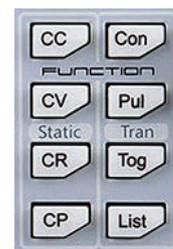
Рис. 9. Органы управления переходом нагрузки в статические и динамические режимы
