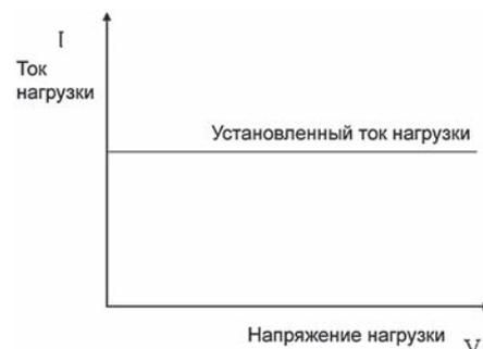
Рис. 3. Зависимость тока от напряжения в режиме постоянного тока (CC)
