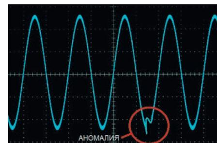
Рис. 3. Аномалия синусоидального сигнала
