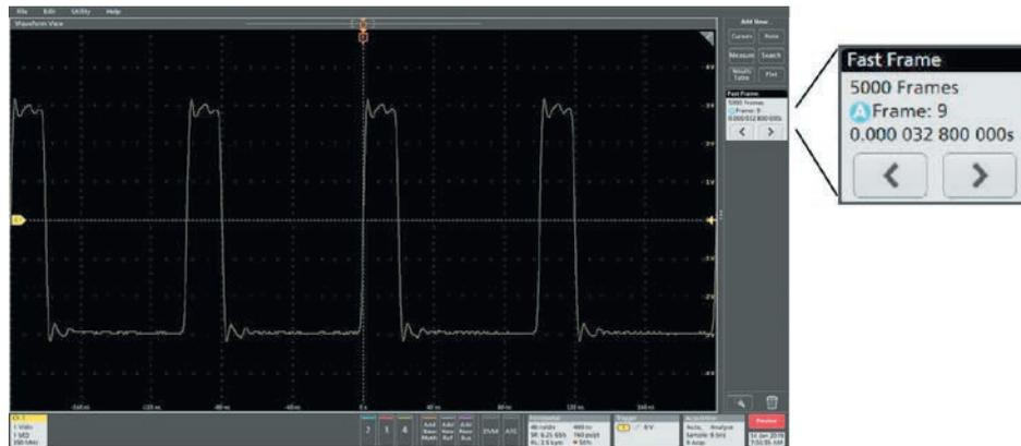
Рис. 15. Захваченный сигнал на дисплее осциллографа Tektronix MSO5, кадры № 1-9 не отображают аномалию
