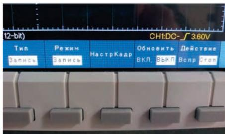
Рис. 7. Меню установки параметров записи ADS-6122
