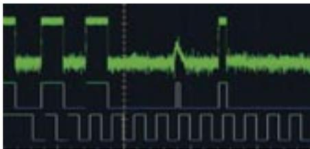
Рис. 7. Глитч на линии SDATA шины I<sup>2</sup>C
