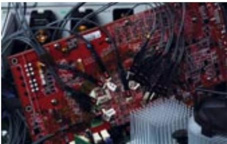
Рис. 4. Дифференциальные логические пробники P6780, подключенные к шине памяти GDDR5 на видеокарте
