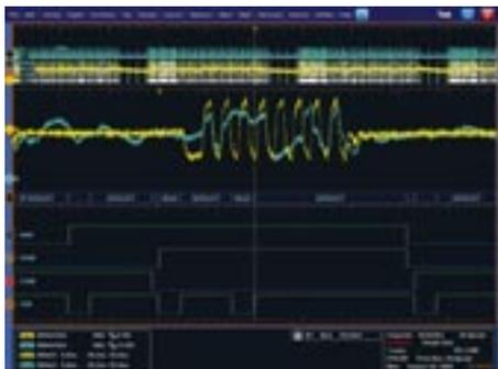
Рис. 3. Запуск по циклу записи в память, использующий классификацию сигналов шины
