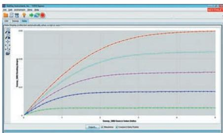
Рис. 6. Это семейство выходных характеристик транзистора MOSFET получено с помощью двухканального SMU, оптимизированного для измерения малых токов
