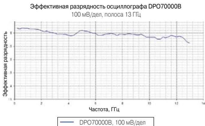
Рисунок 3. Частотная зависимость эффективной разрядности осциллографа DPO70000B при чувствительности 100 мВ/дел.
