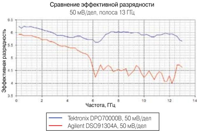
**Рисунок 4.** Сравнение эффективной разрядности двух осциллографов реального времени.
