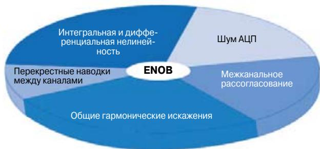
Рисунок 1. Ошибки дискретизатора, влияющие на ENOB (с позволения datatranslation.com).
