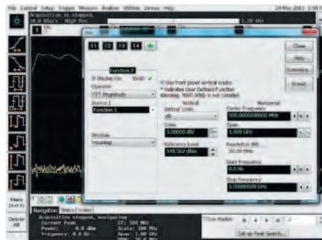
Рис. 5. Примените к импульсной характеристике встроенную функцию FFT Magnitude
