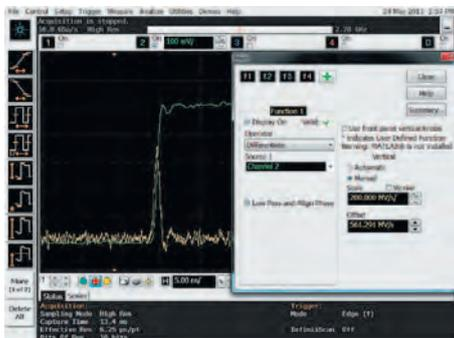
Рис. 4. Использование встроенной математической функции осциллографа для дифференцирования реакции на перепад
