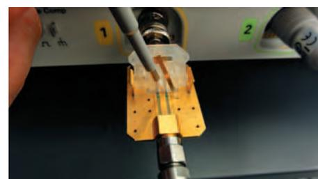
Рис. 2. Измерение источника сигнала сопротивлением 25 Ом с помощью измерительной оснастки Agilent E2655C
