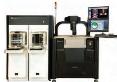
тестирования полупроводниковых изделий. Станция устанавливает новый стандарт в тестировании 300 мм плат при температуре от -60 °C до +200 °C, на данной системе доступны измерения изделий с технологическим процессом 30 нм. Система управляется и находится под контролем специ-
