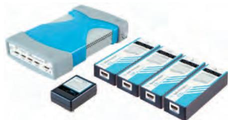
присуждено **анализатору x1149**, Agilent Technologies ([www.agilent.com](http://www.agilent.com)). Анализатор для периферийного сканирования x1149 является универсальным устройством, в то же время, оно отличается простотой в использовании. Данный прибор можно использовать на всех этапах производства плат, начиная с самых ранних — разработки и проверки качества изделия.
