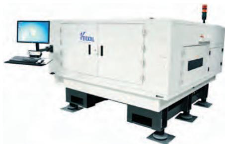
рентгеновских изображений, полученных с нескольких, расположенных под разными углами, камер. Технология гибридной автоматической фокусировки позволяет системе сосредоточиться на желаемой высоте без механического перемещения от рентгеновских лучей, что, в значительной степени, снижает погрешность измерений.
