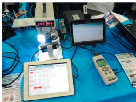
Рис. 15. 4-канальный коммутатор АКТАКОМ AEE-2025 с Web-интерфейсом управления и система регистрации параметров окружающей среды в составе ATE-9538 и программы АКТАКОМ Data Logger Monitor с использованием планшетного компьютера с ОС Android
