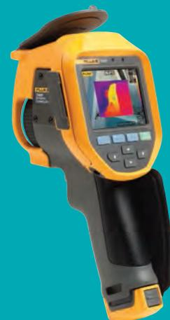
к потере времени и денег. В новых тепловизорах используется система автоматической фокусировки Fluke LaserSharp™, которая позволяет всегда получать идеально сфокусированные изображения за счёт применения технологии лазерных дальнометров. Лазер в тепловизоре безошибочно указывает на нужный вам объект, а значит позволяет получить достоверное изображение и точное измерение температуры
