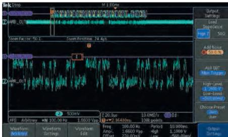
**Рис. 5. Захват поврежденных пакетов на выходе приёмника последовательной шины, индицирующих битовые ошибки**
