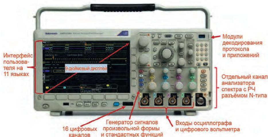
Рис. 1. Комбинированный осциллограф Tektronix MDO3000 предлагает шесть приборов в одном компактном корпусе
