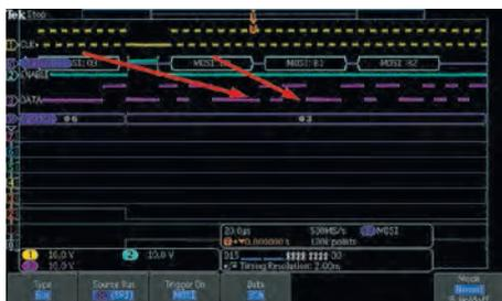
Рис. 3. Стабилизация развертки смешанных сигналов путём запуска по пакету данных с шестнадцатеричным значением В0
