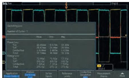
**Рис. 7. Здесь показаны коммутационные потери мощности и энергии**
