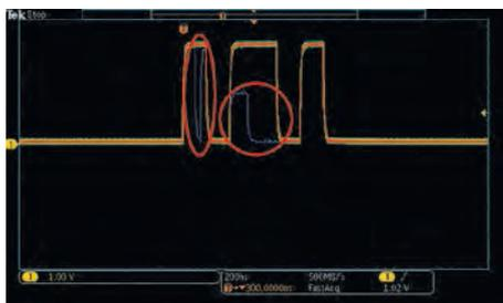
Рис. 2. Функция FastAcq показывает аномалии сигнала на дисплее с градацией цвета
