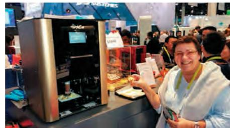
Ещё одним устройством, представленным компанией стал компактный 3D-принтер da Vinci Mini. Этот небольшой принтер на 30% меньше своего предшественника — da Vinci Junior. Габариты модели составляют 400×330×360 мм, рабочий объём при этом всего 150×150×150 мм. Принтер имеет USB-порт, а также Wi-Fi интерфейс. Одним из преимуществ da Vinci Mini является не только его компактность, он отличается простотой использования и отсутствием необходимости в калибровке устройства.
