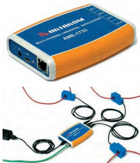
В качестве датчиков используются клампметры типа АМЕ-8821. Система предназначена для измерений потребления тока в одно- и трехфазных сетях непрерывно. Для подключения используются USB и LAN интерфейсы, что позволяет размещать модуль в любом месте здания. В качестве программного
