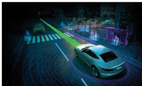
ных средствах функции искусственного ума. Платформа базируется на двух микропроцессорах Tegra следующего поколения и двух дискретных графических чипах на архитектуре Pascal. Платформа Drive PX 2 базируется на разработках глубокого обучения, содержит в себе современные библиотеки и примитивы компьютерного зрения. В композиции эти средства обеспечивают впечатляющие способности обнаружения и отслеживания объектов.
