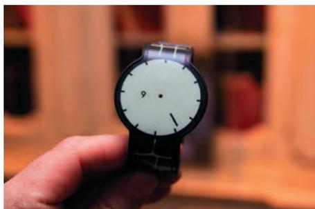
презентация ещё одной новинки — часов FES Watch, выполненные с применением технологии e-paper или электронной бумаги. Такая технология позволяет формировать изображение в отражённом свете, как самая обычная бумага, и может хранить изображение текста и графики в течение достаточно длительного времени, не потребляя при этом электрической энергии и затрачивая её только на изменение изображения.
