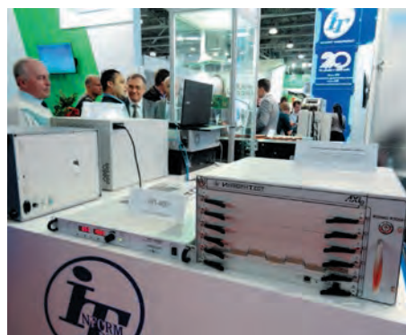
Рис. 17. Источник питания ИП-400 (слева) и 6-слотовое шасси формата AXIe-0 (справа)
