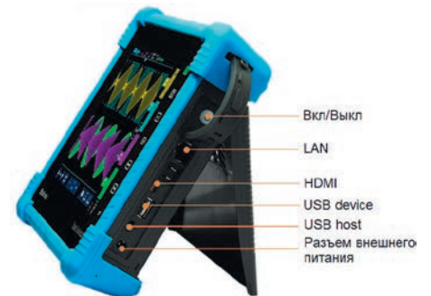
Рис. 3. Вид на разъемы интерфейсов прибора. Задняя крышка откинута для демонстрации возможности вертикальной установки прибора
