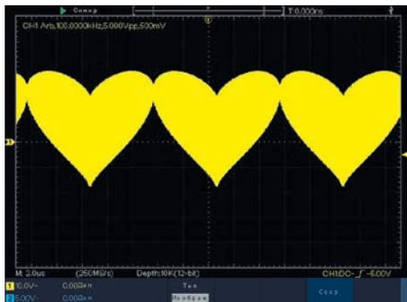
Рис. 14. «Сердцевидный» сигнал, сформированный на встроенном генераторе сигналов
