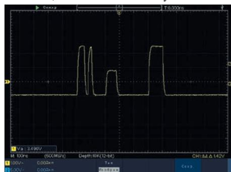
Рис. 3. Синхронизация по рангу в ADS-6000(Н) позволяет выделить в потоке данных импульсы нестандартной амплитуды
