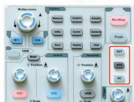
Рис. 16. Органы управления встроенным генератором сигналов
