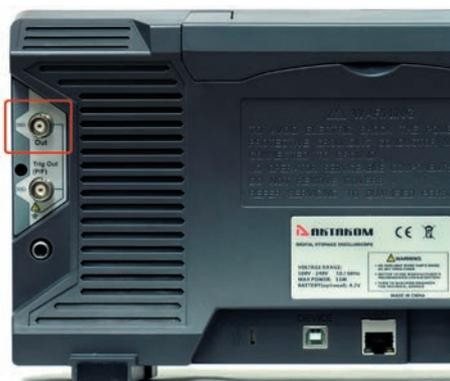
Рис. 15. Задняя панель прибора со встроенным генератором сигналов
