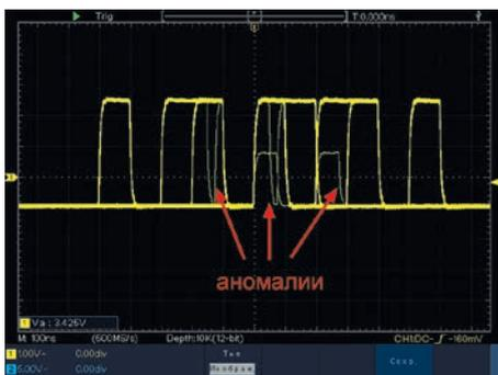
Рис. 2. Обнаружение редких аномалий сигнала с помощью АКТАКОМ ADS-6000 возможно благодаря высокой скорости захвата осциллограмм
