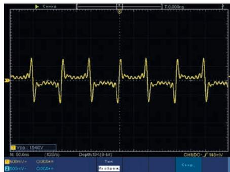
Рис. 6. Вид сигнала в режиме генерации гармоник
