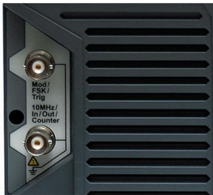
Рис. 12. Подключение внешнего источника модуляции и вход/выход опорной частоты
