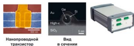
Рис. 5. Модульный источник/измеритель на базе шины USB Agilent U2722A, используемый для тестирования транзисторов на основе кремниевого нанопровода транзисторов. Показано сечение устройства
