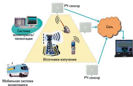
Рис. 1. Система спектрального мониторинга и контроля
