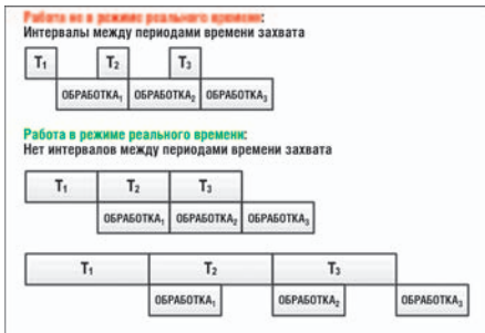
Рис. 2. Работа в режиме реального времени имеет место, когда скорость вычислений достаточно высока, чтобы обеспечить анализ дискретизированных данных без интервалов между периодами времени захвата T . В этом случае каждая процедура вычислений (РАСЧЕТ) включает вычисление БПФ или спектра мощности, а также усреднение, обновление дисплея и т.д.
