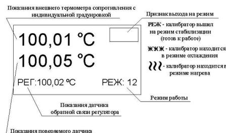
Рис. 2. Вид индикатора калибраторов серии КС
