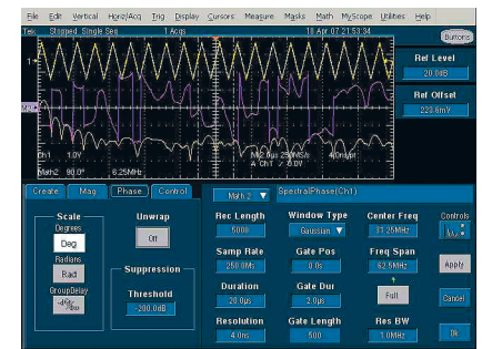
Рис. 14. Пример спектрального анализа без настройки осциллографа TDS5034B
