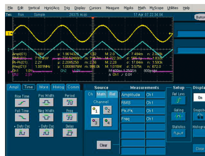
Рис. 13. Настройка вывода результатов автоматических измерений у осциллографа TDS5000
