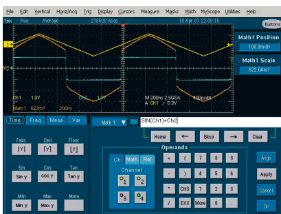
Рис. 12. Пример построения осциллограммы сигнала SIN(CH1)+CH2 осциллографом TDS5000
