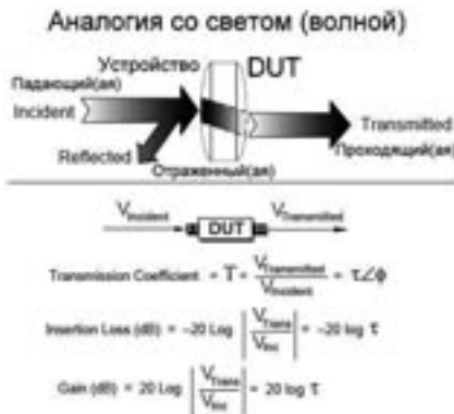
Рис. 25. Аналогия со светом и волной при исследовании 4-полосников
