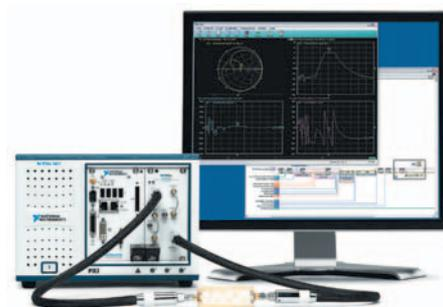
Рис. 2. Векторный анализатор цепей PXIe-5632 предоставляет возможность калибровки встроенного генератора по внешнему измерителю мощности. Также на ВЧ-тракте возможно подключение дополнительных устройств в калибровочную цепь для учета их при калибровке
