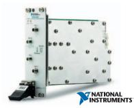
Векторный анализатор цепей NI PXIe-5630 оптимизирован для использования в системах автоматизированного тестирования благодаря целому спектру возможностей, таких как автоматическая прецизионная калибровка, полнофункциональный векторный анализ в обоих каналах, готовый набор библиотек функций в LabVIEW. Рабочий диапазон частот прибора — от 10 МГц до 6 ГГц; динамический диапазон — 110 дБ, скорость перестройки менее 400 мкс при 3201 точках.
