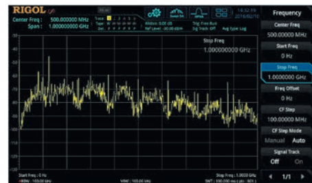
Рис. 4. Отображение спектра в режиме свипирующего анализатора
