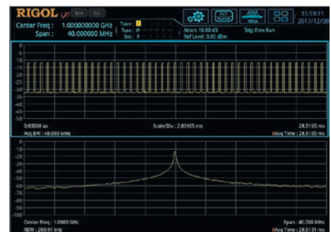
Рис. 24. Отображение распределения мощности во времени и обычного спектра
