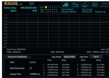
Рис. 16. Измерение гармонических искажений
