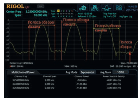
Рис. 12. Измерение мощности в нескольких каналах
