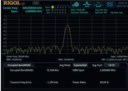
Рис. 13. Измерение занимаемой полосы
