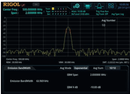
Рис. 14. Измерение ширины полосы передачи
