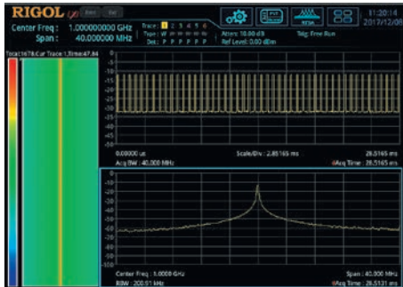
Рис. 25. Представление одновременно трех окон на одном экране
