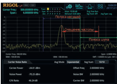
Рис. 15. Измерение отношения сигнал/шум
