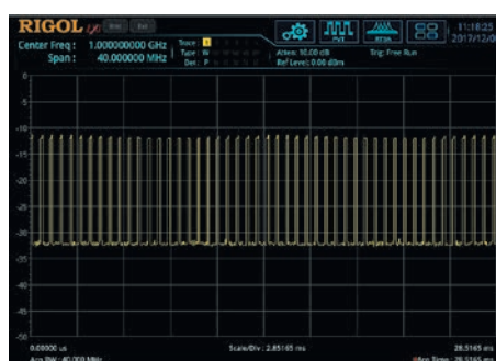
Рис. 22. Отображение распределения мощности во времени
