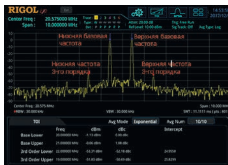
Рис. 17. Измерение интермодуляционных искажений третьего порядка
