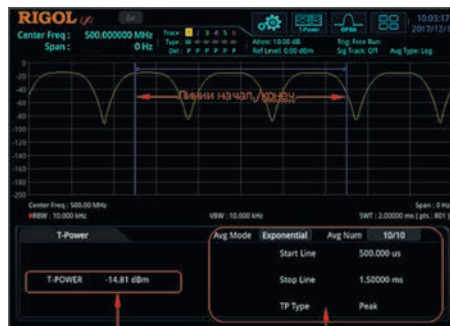
Рис. 10. Измерение мощности во временном интервале
