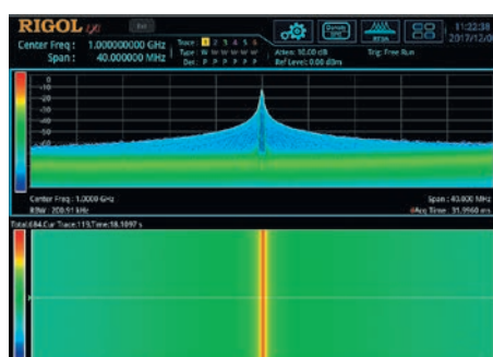
Рис. 23. Отображение спектрограммы со спектральной плотностью
