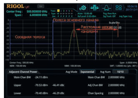
Рис. 11. Измерение мощности в смежных каналах
