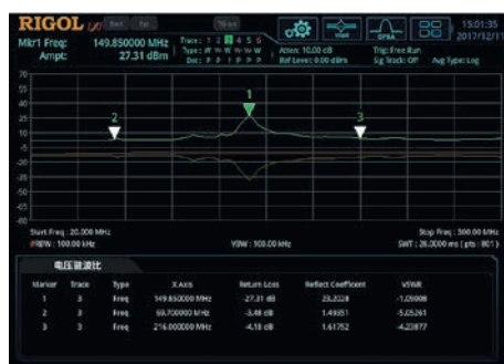
Рис. 9. Измерение обратных потерь, коэффициента отражения и коэффициента стоячей волны по напряжению
