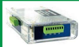
генератор сигналов произвольной формы, 16-канальный логический анализатор, 16-канальный генератор цифровых последовательностей) и предназначен для комплексного исследования многофункциональных аналогово-цифровых электронных устройств.
