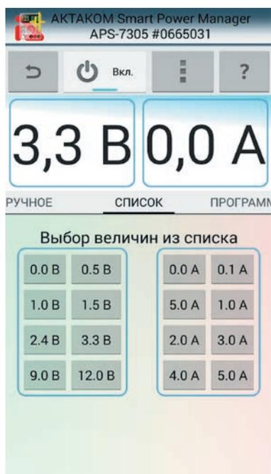
Рис. 11. Режим работы по списку для дистанционного управления лабораторным источником питания АКТАКОМ APS-7305L в программе Aktakom Smart Power Manager
