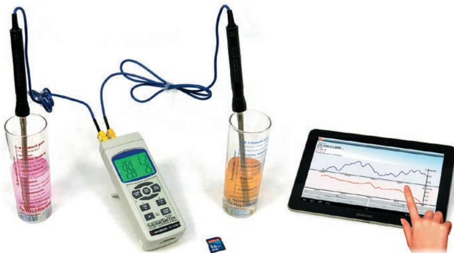
Рис. 6. АКТАКОМ Data Logger Monitor для Android, дистанционные измерения на рабочем месте
