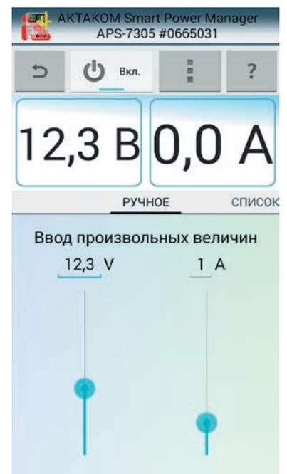
**Рис. 10. Режим ручного дистанционного управления лабораторным источником питания АКТАКОМ APS-7305L в программе Aktakom Smart Power Manager**
