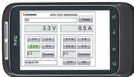
**Рис. 8. Web-интерфейс источника питания АКТАКОМ APS-7305L, не требующий установки программного обеспечения для удаленного доступа на ПК**
