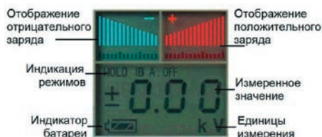
Рис. 8. Дисплей прибора с результатами измерений и служебными символами
