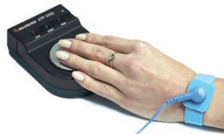
Рис. 2. Проверка сопротивления цепи антистатического браслета прибором ATP-9355
