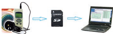
Рис. 4. Сохранение и перенос данных в формате Excel с использованием карты SD в анемометрах АКТАКОМ
