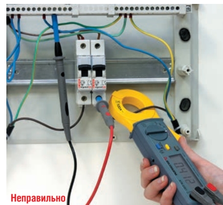
Рис. 5. Неправильное подключение токовых клещей для измерения коэффициента мощности
